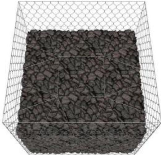
За один раз заполняется коробчатый габион на 1/3. После чего фиксируется внутри горизонтальной стяжкой поверх уложенного камня, стяжка делается из вязочной проволоки, на высоте 1/3 и 2/3 габиона. Такая технология применяется только для коробчатых габионов высотой 1 м. Для коробчатых габионов
